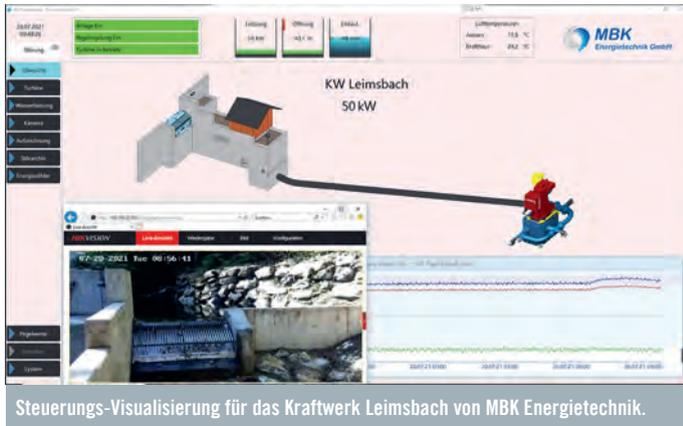
Steuerungs-Visualisierung für das Kraftwerk Leimsbach von MBK Energietechnik.
